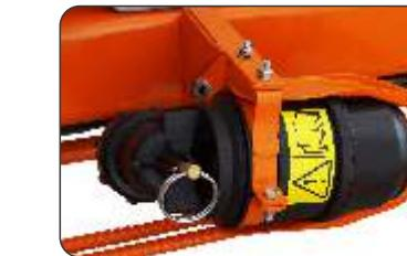
O filtro de sucção tem a função de reter todo e qualquer tipo de impureza antes que a mesma atinja a bomba de defensivo.
