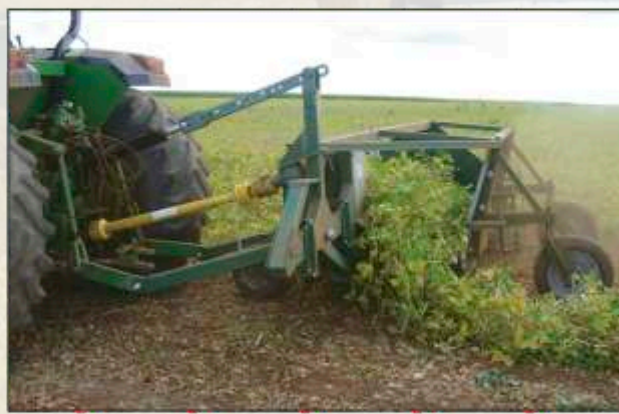
4 - A esteira transportadora enleira as plantas de feijão (6 linhas) na parte traseira do trator.
