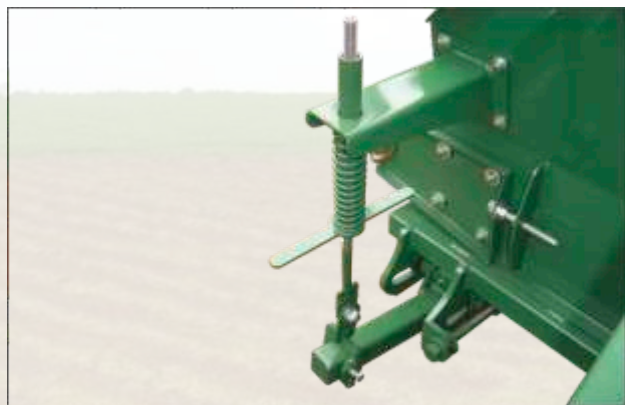
1 - Os braços que sustentam o sistema de corte possui molas para facilitar a flutuação e acompanhar melhor as irregularidades do solo.
