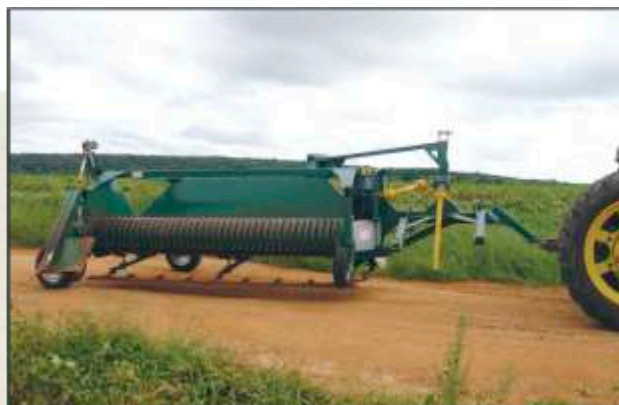
2 - Possui sistema de engate na barra de tração para facilitar o transporte.
