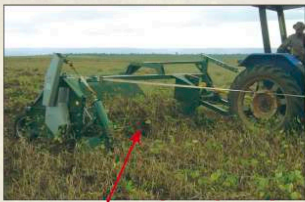
3 - Dedos flexíveis com envoltórios para levantar as plantas sem causar perdas de vagens mesmo em feijões mais secos.
